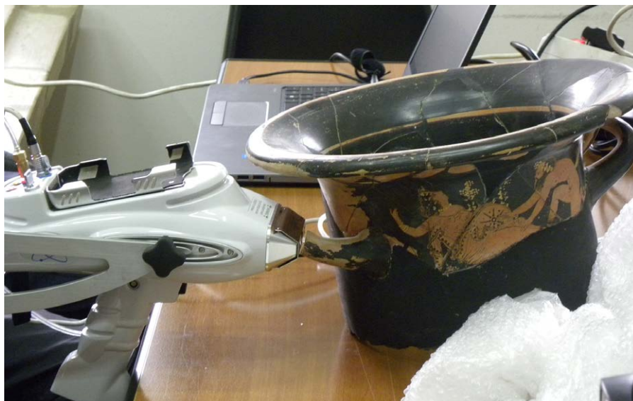
Fig. 4 - Analisi con fluorescenza portatile a raggi X sul cratere a figure rosse del Pittore Prado-Fienga (inv. 298) presso il Museo Archeologico Regionale di Gela
